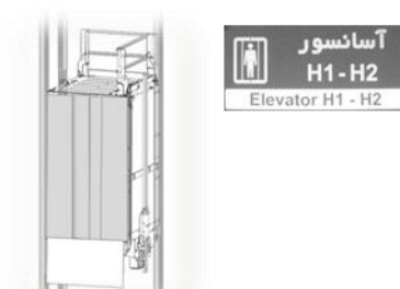
مکانیزم خروج اضطراری به سقف کابین
